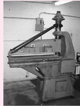
Schwabe Mdl. D 25 Ton Hydraulic Clicker Die Cutting Press
